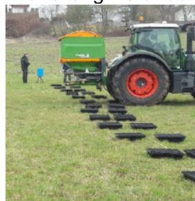
Abb. 2: Überprüfung der Querverteilung mit Streuschalen
