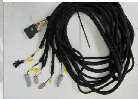
Hauptkabelsatz außerhalb der Fahrerkabine
