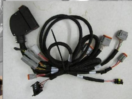
Hauptkabelsatz in der Kabine
